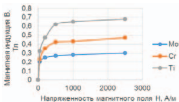
Рис. 7. Основные кривые намагниченности образцов порошкового терромагнитного сплава с различными добавками
