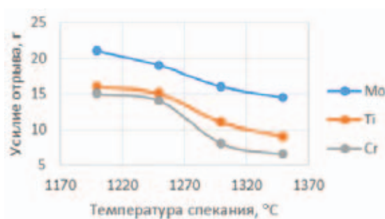
Рис. 6. Зависимость усилия отрыва от температуры спекания и легирующих добавок
