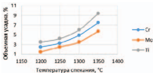
Рис. 3. Зависимость объемной усадки образцов сплавов Fe-Ni с немагнитными добавками от температуры спекания
