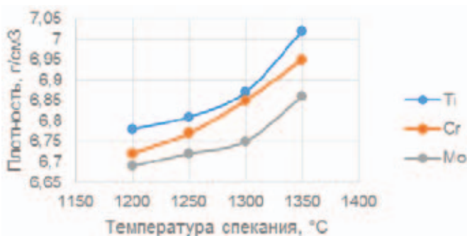
Рис. 4. Зависимость плотности образцов сплава Fe – Ni от температуры спекания
