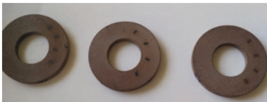
Рис. 6. Сліди зносу ОКП на сплаві 2024 після випробувань на тертя
