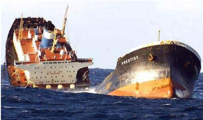
Рис. 1. Танкер «Престиж» после катастрофы в Атлантическом океане у берегов Испании 13.11.2002 г., когда во время шторма в однокорпусном судне водоизмещением 42800 т образовалась трещина, в результате чего судно 19.11.02 судно раскололось на две части и затонуло. В море вылилось около 50 тыс. т нефти, экономический ущерб от которой составил 4 млрд. евро.
