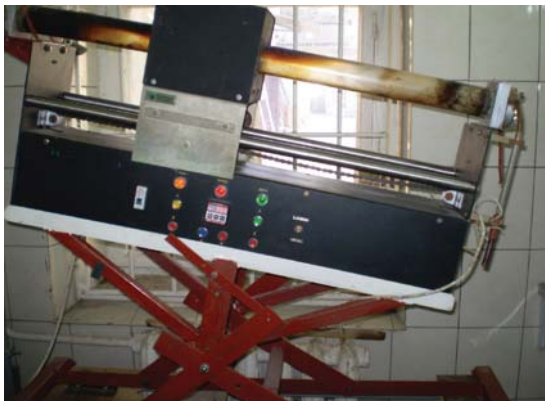
Рис. 1 Експериментальна установка для випробування кабельної та електротехнічної продукції згідно з патентом [18]
