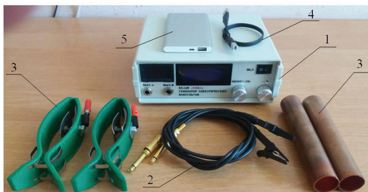
Рис. 4. Внешний вид генератора с комплектом необходимого оборудования. 1 — генератор VEB-1; 2 — два шнура с разъемами JACK и контактными зажимами для подключения к выходам OUT-A и OUT-B; 3 — контактные площадки или трубки; 4 — кабель питания с разъемами USB-B и USB-A; 5 — аккумуляторная батарея 5 В.
