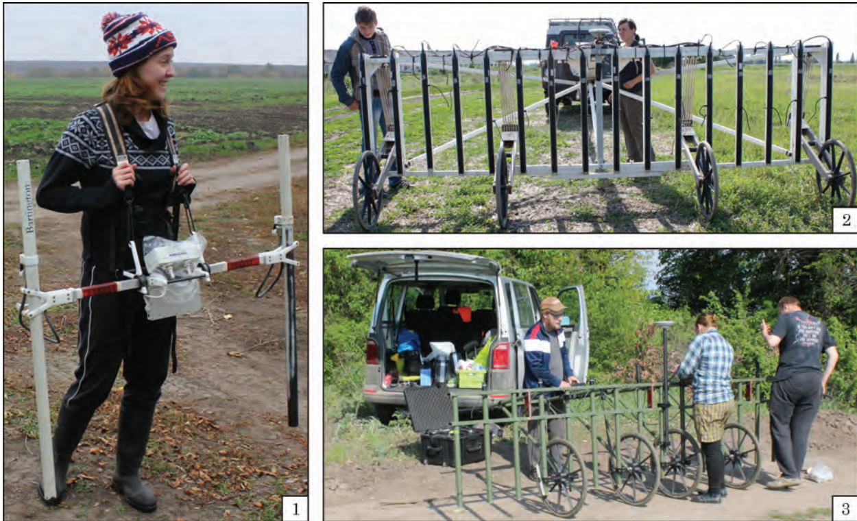
Рис. 1. Зразки геофізичного обладнання, використаного для дослідження пам'яток трипільської культури в Україні у 2009—2018 рр.: 1 — з Великої Британії; 2, 3 — з Німеччини
