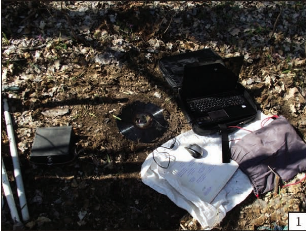
Рис. 2. Розвідувальне буріння на палеолітичному місцезнаходженні Наплавна Дача, 2014 р. (Станично-Луганський р-н, Луганська обл.). 1 — обладнання для фото та відео зйомки в свердловині; 2 — відеокамера у свердловині
