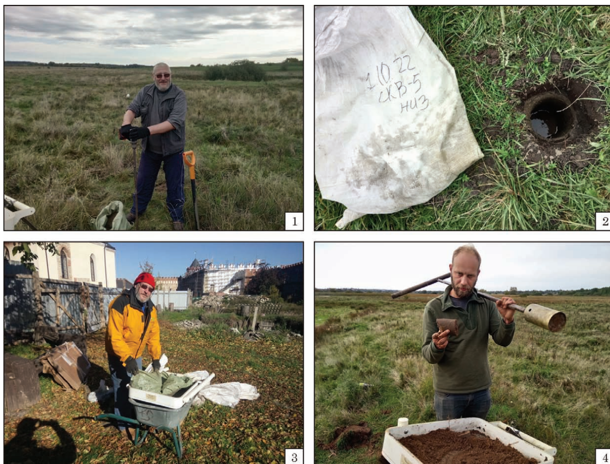
Рис. 6. Буріння розвідувальних свердловин модифікованим обладнанням: 1 — ручний бур з електроприводом; 2 — відбір кернів на промивку; 3 — промивка кернів на базі; 4 — Є. Поляченко на просіві кернів біля свердловини
