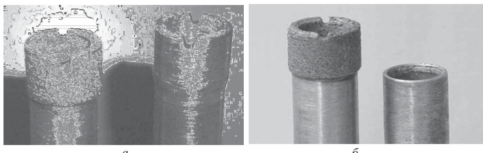
Алмазные сверла до (а) и после (б) испытаний. Слева — опытное сверло, справа — серийное
