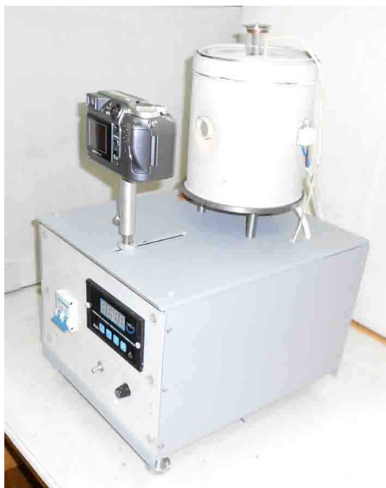
Рис. 1. Загальний вигляд випробувального стенда для визначення крайового кута змочування металевими розплавами твердих поверхонь
