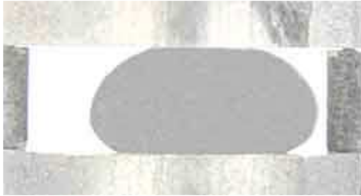
Рис. 7. Профіль краплі олова на сапфірі, розплавленій при температурі 700 °С у вакуумі
