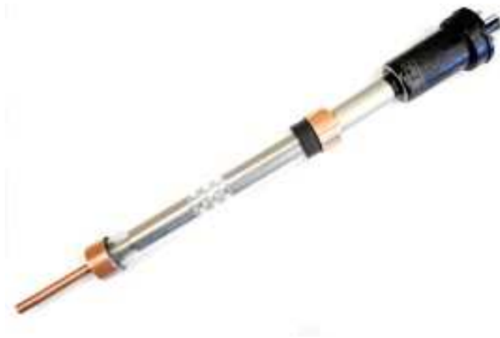
Рис. 5. Збірна герметична кварцово-металева касета для вимірювання крайового кута змочування у вакуумі в умовах МКС
