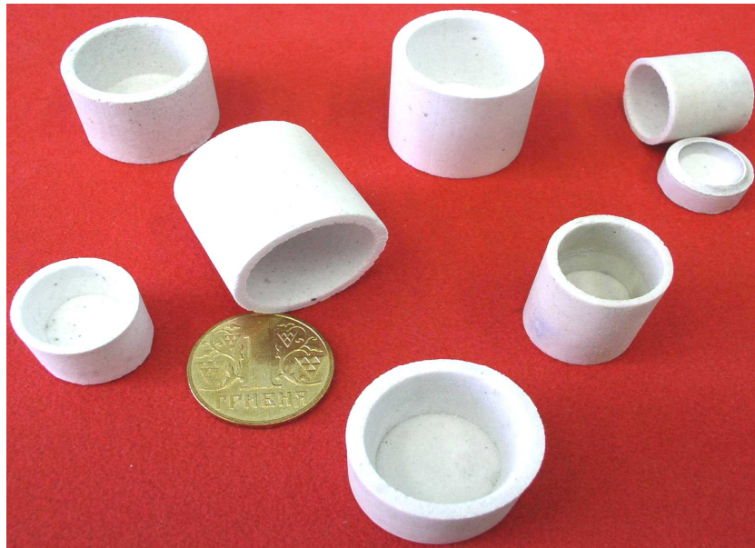
Рис. 1. Тиглі та чашки для гомогенізації та ізотермічного плавлення хімічно активних сплавів з великим вмістом (до 80% (мас.)) Ti, Zr, Nb, V
