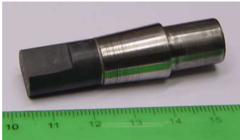
Рис. 5. Спаї кераміки \text{Si}_3\text{N}_4 та сталі, що виготовлено за допомогою припійної стрічки \text{Cu—Sn—Ti} при температурі 1173 К
