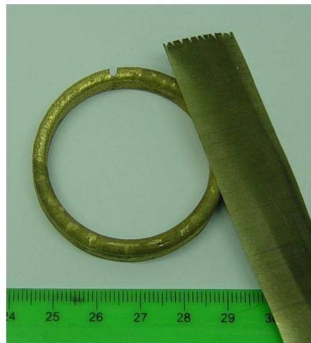
Рис. 4. Стрічки, що отримано із сплаву Cu—Sn—Ti
