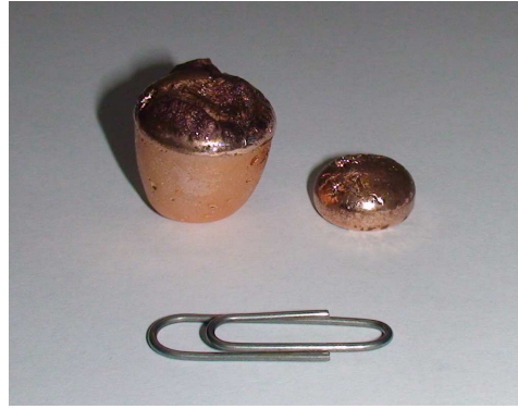
Рис. 3. Зливки металів/сплавів, виплавлені/синтезовані в атмосфері \text{CO}_2 , наближеній до марсіанської (тиск у камері — \sim 0,01\text{—}0,001 МПа): a — Cu (тигель із \text{Al}_2\text{O}_3 , маса — 40 та 15 г); б — сплав Cu—Ag (72%) (графітовий тигель, маса 12 г)
