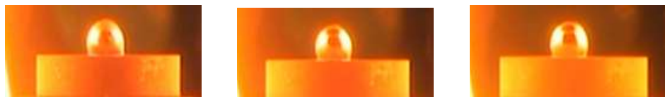
Рис. 5. Змочування підкладки із сталі 45 припоем ПСР-72 в атмосфері \text{CO}_2 ( 0,01\text{—}0,001 МПа): a — 820 °С, \theta = 95^\circ ; б — 850 °С, \theta = 105^\circ ; в — 930 °С, \theta = 105^\circ
