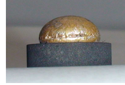
Рис. 3. Зливки металів/сплавів, виплавлені/синтезовані в атмосфері \text{CO}_2 , наближеній до марсіанської (тиск у камері — \sim 0,01\text{—}0,001 МПа): a — Cu (тигель із \text{Al}_2\text{O}_3 , маса — 40 та 15 г); б — сплав Cu—Ag (72%) (графітовий тигель, маса 12 г)
