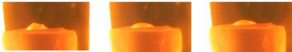
Рис. 4. Змочування підкладки із нікелю сріблом в атмосфері \text{CO}_2 ( 0,01\text{—}0,001 МПа): a — 960 °С, початок плавлення; б — 980 °С, \theta = 37^\circ ; в — 1010 °С, \theta = 34^\circ
