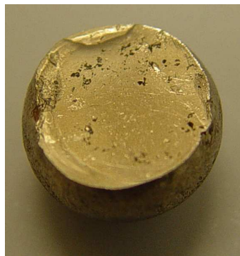
Рис. 5. Фотографії зони контакту крапель мідь—олово—титан, що охолоджено, при 1170 ( a ), 1270 ( б ) та 1470 К ( в )
