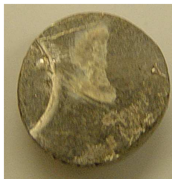
Рис. 5. Фотографії зони контакту крапель мідь—олово—титан, що охолоджено, при 1170 ( a ), 1270 ( б ) та 1470 К ( в )
