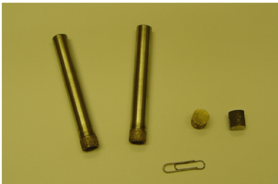
Рис. 1. Алмазные трубчатые свёрла и образцы связки этих инструментов, предназначенные для испытаний
