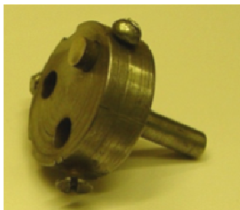
Рис. 2. Устройство для размещения и закрепления образцов связки
