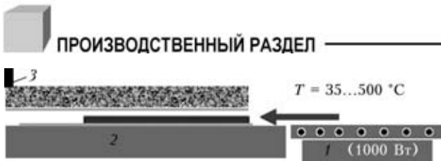
Рис. 7. Схема плакирования взрывом с предварительным подогревом: 1 — нагреватель (1000 Вт); 2 — основание; 3 — детонатор
