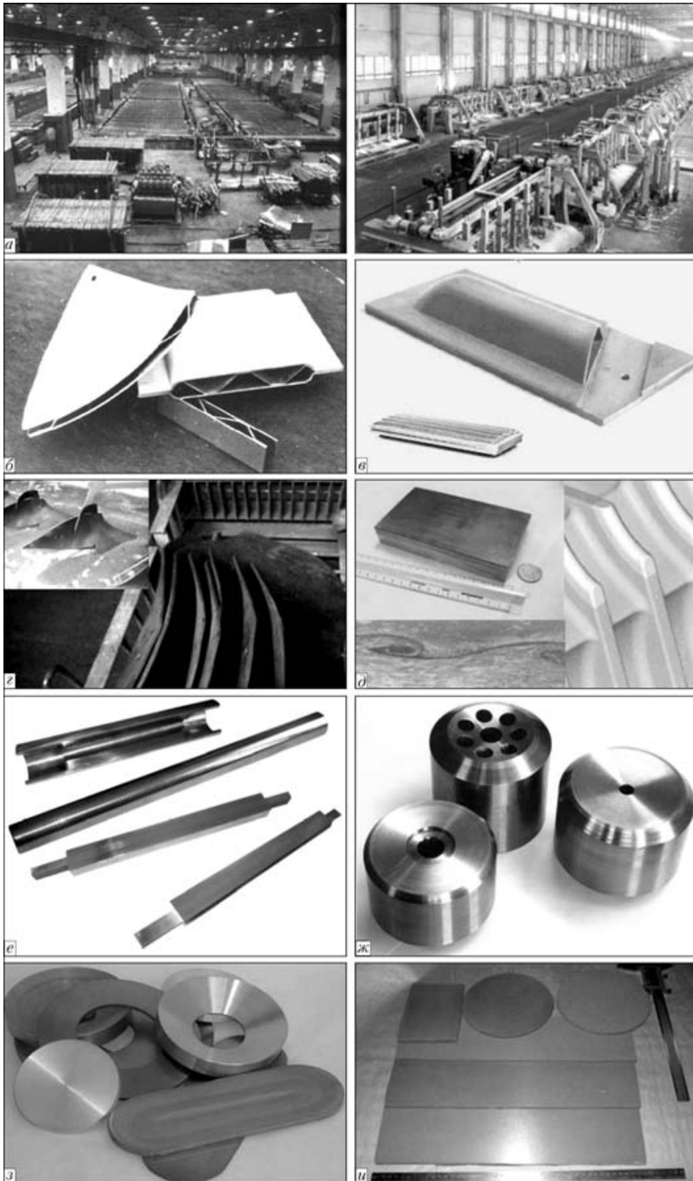
Рис. 8. Материалы и изделия, полученные способом сварки и консолидации взрывом: а — переходники электролизеров медь–титан и алюминий–сталь повышенной термостойкости; б — панели из легких сплавов алюминия; в — теплообменники титан–медь, алюминий–титан; г — рабочие органы почвообрабатывающих машин; д — заготовки из циркониевой бронзы и молибдена; е — многослойные композиционные материалы; ж — заготовки коаксиально плунжерных насосов; з, и — композиционные изделия для микроэлектроники Cr, Ti–W, Ni–Cr–Si ( з ) и силициды Ti, W, Mo, Ta ( и )
