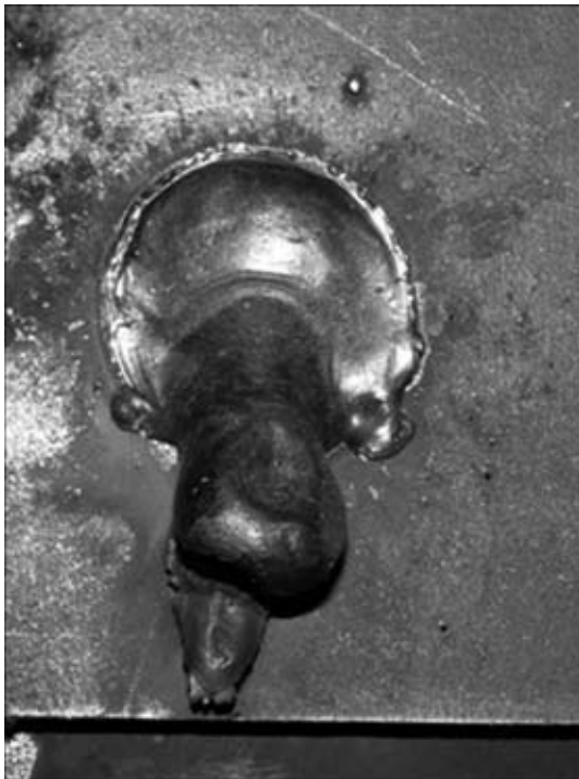
Рис. 2. Точечное соединение, полученное в вертикальном положении на режимах, используемых при ДТС в нижнем положении
