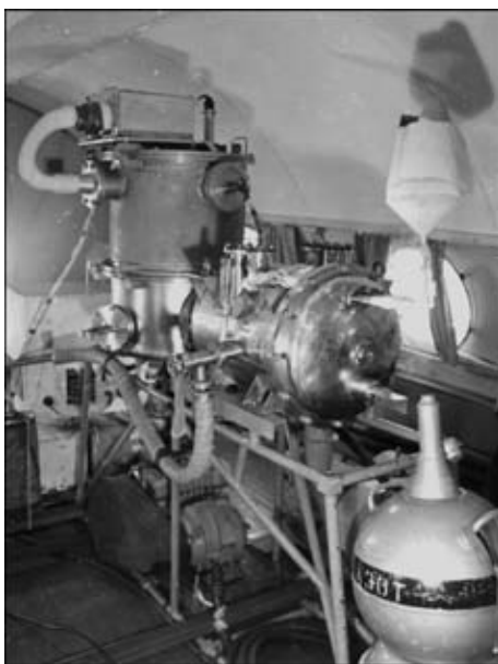
Рис. 1. Установка для электронно-лучевой сварки образцов при комнатной и низкой температурах в условиях кратковременной невесомости на борту ЛЛ Ту-104А
