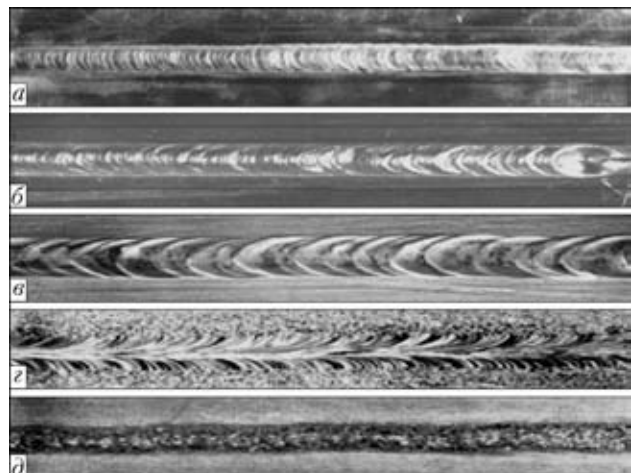
Рис. 3. Внешний вид сварных соединений сплавов АМг6 (а), 1201 (б), АМг3 (в), АД0 (г) и ИМВ-2 (д), полученных электронно-лучевой сваркой в условиях кратковременной невесомости на ЛЛ Ту-104А
