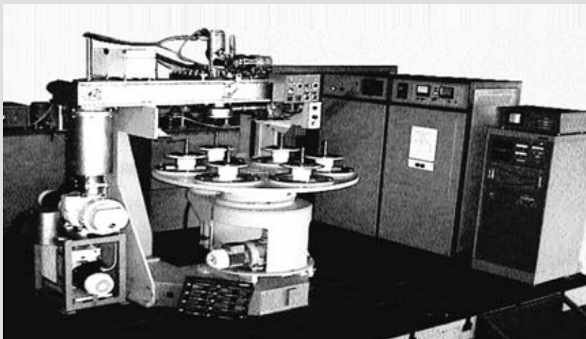
Промышленные установки тактового типа (УЛ-157, АВТО-ЗА3, Мелитополь) применяются для сварки блоков шестерен коробок передач
