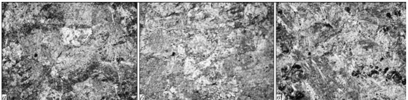
Рис. 2. Микроструктуры (X500) металла ЗТВ колесной стали типа Т при w_{6/5} = 20,0 (а), 11,1 (б) и 7,7 °С/с (в)
