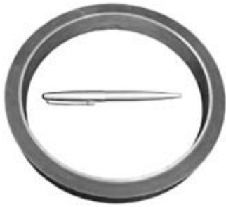
Рис. 12. Макрошлиф поперечного сечения втулки
