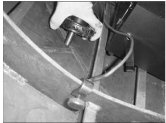
Рис. 4. ЭДО сварных соединений усиления кормы корпуса ТК
