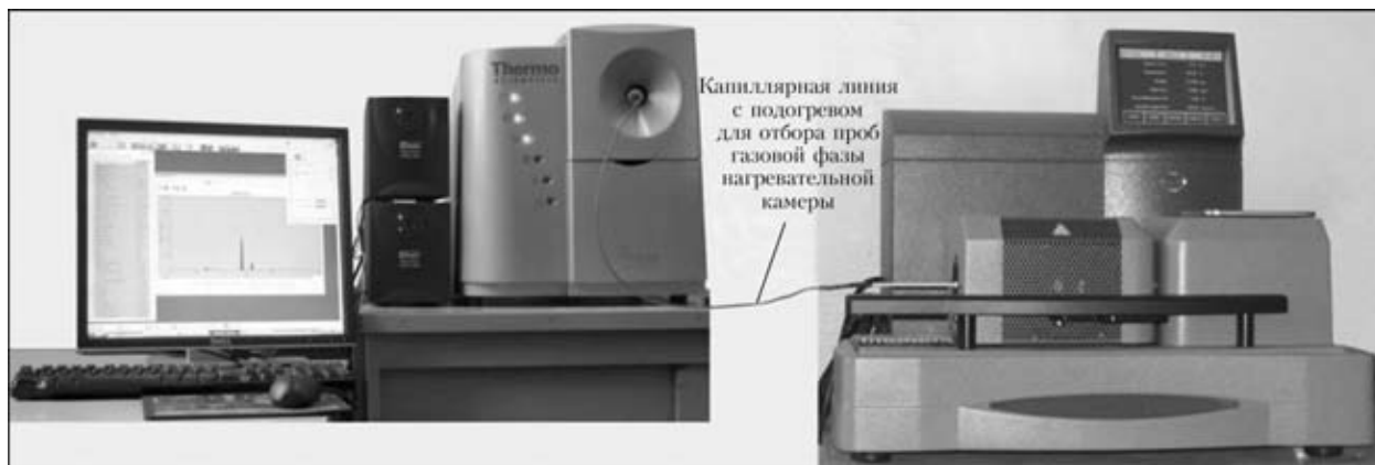
Рис. 1. Термоанализатор TGA/DSC Q600 STD (справа), совмещенный с масс-спектрометром VG ProLab (слева), для мониторинга и анализа состава газовой фазы его нагревательной камеры
