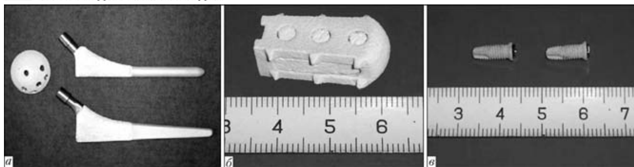
Рис. 4. Примеры изделий с биокерметным покрытием, полученным микроплазменным напылением: а — эндопротезы тазобедренного сустава; б — металлокерамический имплантат для межтелового спондилодеза; в — стоматологический имплантат
