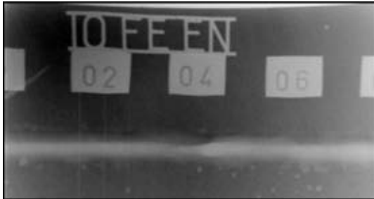
Рис. 14. Рентгенограмма участков в области нахлестки стартовых зон (положение 12 ч)
