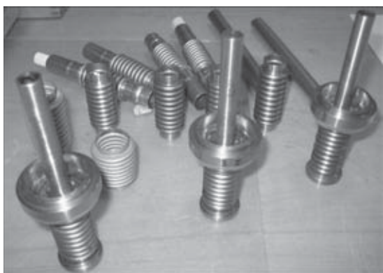
Рис. 6. Образцы многослойных сильфонов, изготовленных с применением лазерной сварки трубных заготовок из стали 1.4541 \delta = 0,15 мм
