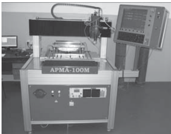
Рис. 5. Внешний вид трехкоординатного комплекса типа «АРМА-100М» для лазерной сварки
