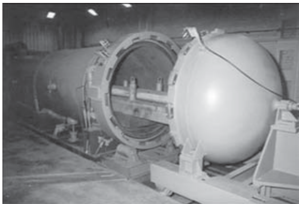
Рис. 1. Взрывная камера КВГ-16 с выдвинутым рабочим столом
