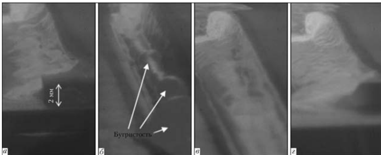
Рис. 9. Влияние защитного газа в нахлесточном соединении на образование бугров (сталь S420MC толщиной 2 мм, v_w = 10 м/мин, кадры позади процесса сварки): а, б — без защитного газа; в, г — с защитным газом Ar + O 2
