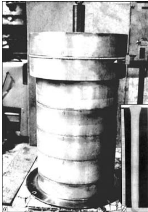
Рис. 9. Внешний вид сварной обечайки с переменной толщиной стенки из поволоки сплава АМгб ( а ) и макрошлиф соединения ( б )
