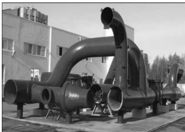
Рис. 2. Опытный стенд с искусственными и естественными дефектами
