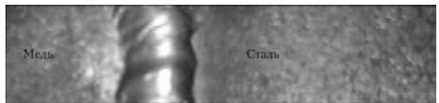
Рис. 8. Бездефектное сварное соединение меди со сталью
