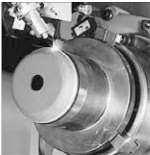
Рис. 2. Лазерное легирование элементов штамповой оснастки для горячего деформирования, изготовленных из стали 1.2365 (X32CrMoV3-3) [42]
