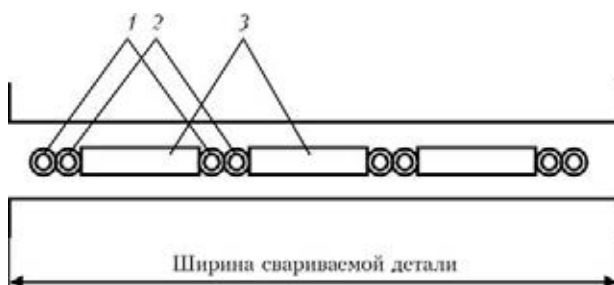
Рис. 2. Схема плавящихся мундштуков с каналами для подачи проволоки (вариант на одну фазу): 1, 2 — каналы для перемещения сварочных проволок рабочих и дублирующих соответственно; 3 — пластины плавящегося мундштука
