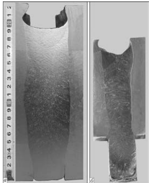
Рис. 5. Макроструктуры сварных соединений (продольное сечение), выполненных стандартной ЭШС (а) и ЭШС в узкий зазор (б)
