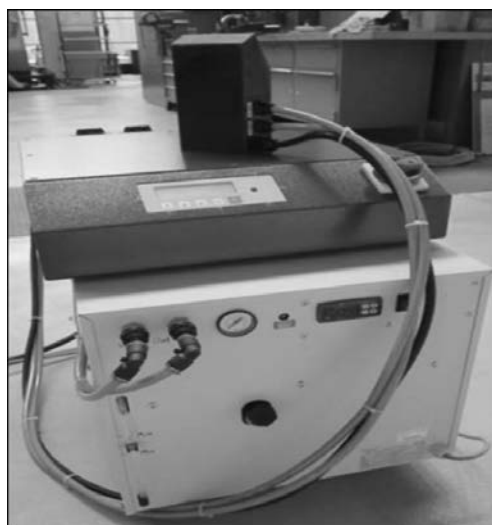
Рис. 5. Коаксиальный индуктор KI-112-U-30° с генератором импульсов EW100W и чиллером
