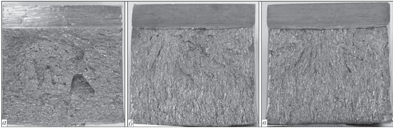
Рис. 9. Поверхность излома ударных образцов Шарпи при надрезе по центральной линии прокатки: а — KCV = 9,8 Дж/см 2 ; б — 22,2; в — 30,8
