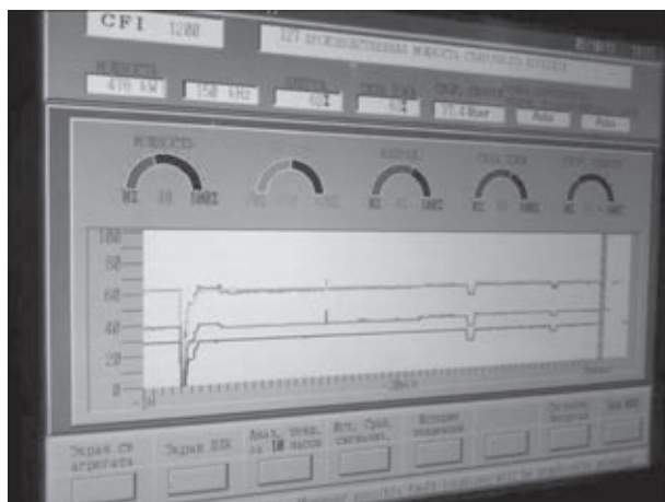
Рис. 1. Контроль параметров высокочастотной сварки трубы пайп НМТЗ». Модернизация технологического оборудования проведена с учетом передового зарубежного опыта и рекомендаций ИЭС им. Е. О. Патона. Новое технологическое оборудование поставлено предприятиями Австрии, Великобритании, США, ФРГ, Франции, Кореи, Голландии и Чехии.
