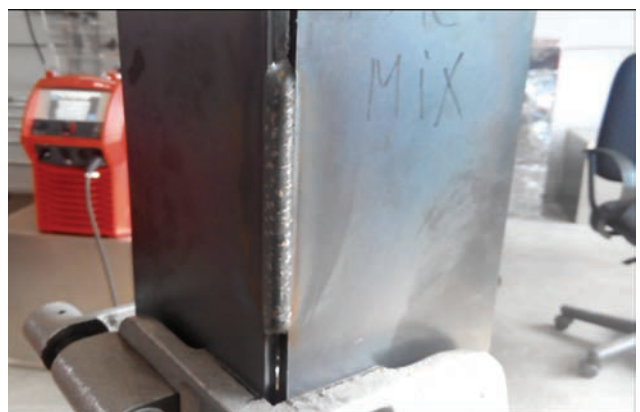
Сварка по зазору, корневой проход сварочный процесс LSC Root (положение PG), заполняющий — PMC-MIX (без колебаний, положение PF). Преимущества: стабилизация длины дуги, отсутствие брызг, высокая стабильность сварочной дуги
