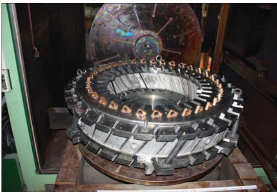
Рис. 4. Внешний вид наружной части переднего корпуса КСД, установленного на вращатель с вертикальной осью вращения для ЭЛС наружных стыков стоек
