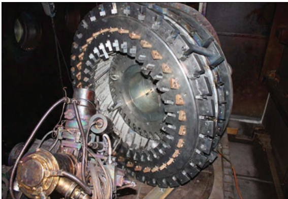
Рис. 7. Внешний вид наружной части переднего корпуса КСД, установленного на вращатель с горизонтальной осью вращения для ЭЛС внутренних стыков стоек. Электронно-лучевая пушка установлена под углом \angle VG = 35^\circ
