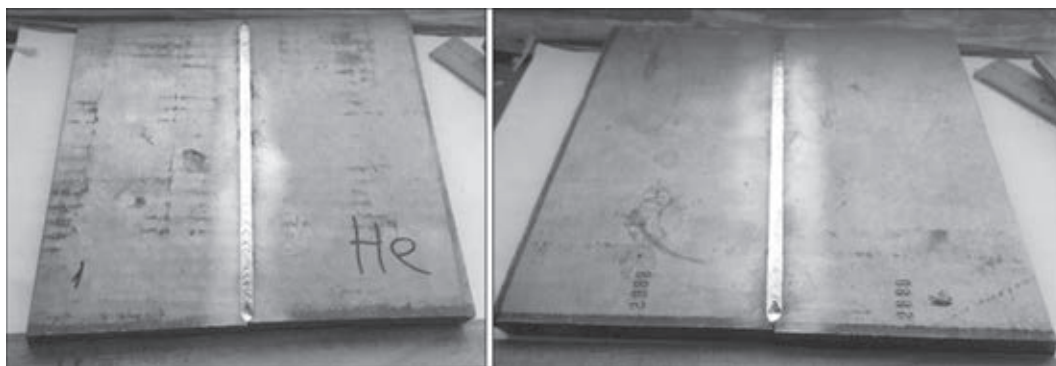
Рис. 3. Внешний вид сваренных в газовой среде He + Ar + Ar с двух сторон пластин сплава технического титана VT1-0 ДШП толщиной 12 мм, упрочненного азотом (0,098 мас. %)
