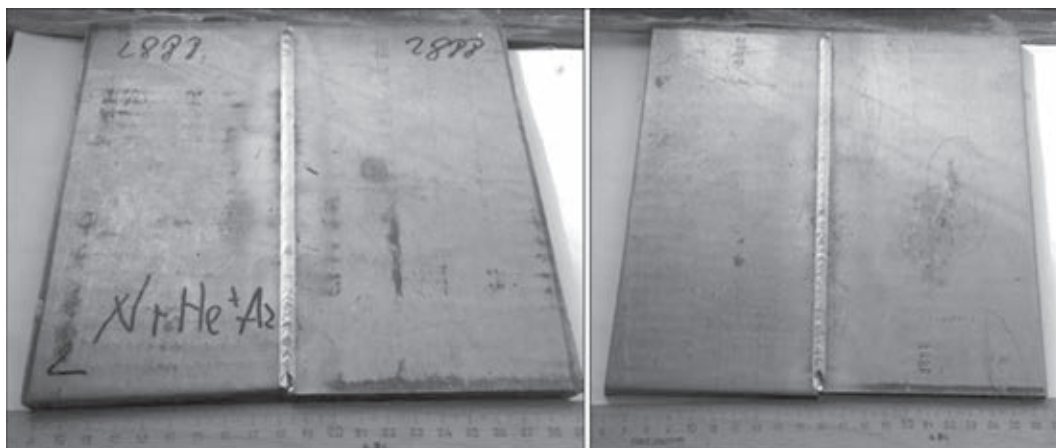
Рис. 4. Внешний вид сваренных в газовой среде He + N 2 + Ar с двух сторон пластин сплава технического титана VT1-0 ДШП толщиной 12 мм, упрочненного азотом (0,098 мас. %)
