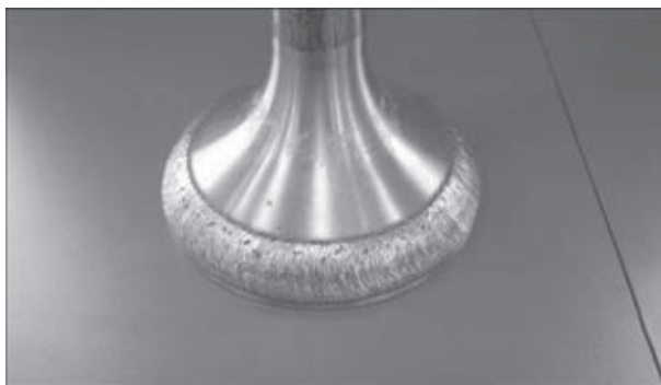
Рис. 8. Наплавка вентиля сплавом Stelloy 21-G
