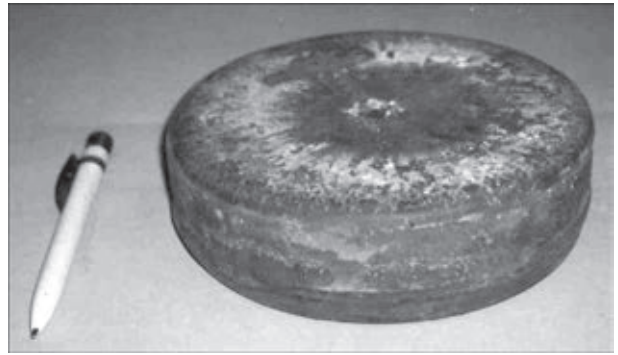
Рис. 3. Внешний вид наплавленной таблетками заготовки
