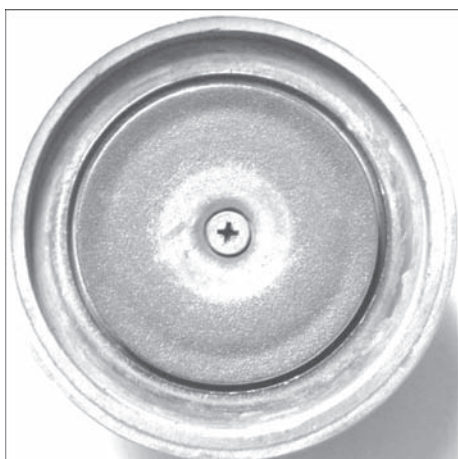
Рис. 2. Составная мишень Al + Fe с вставкой ( d = 64 мм, \delta = 3 мм) из стали Ст.3
