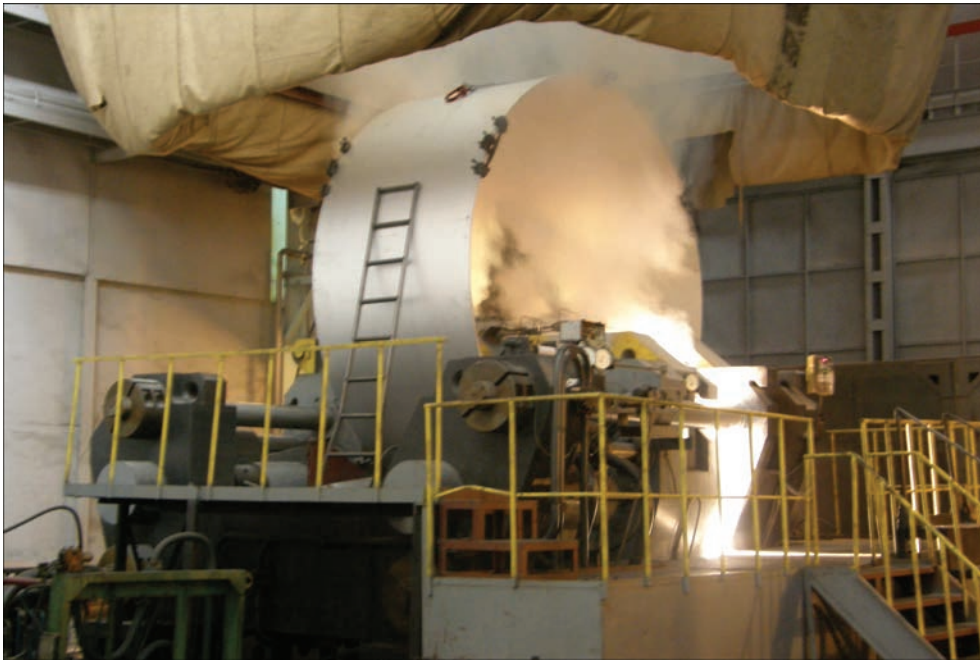
Контактно-стикове зварювання корпусів РН «Зеніт» (машина К825)
