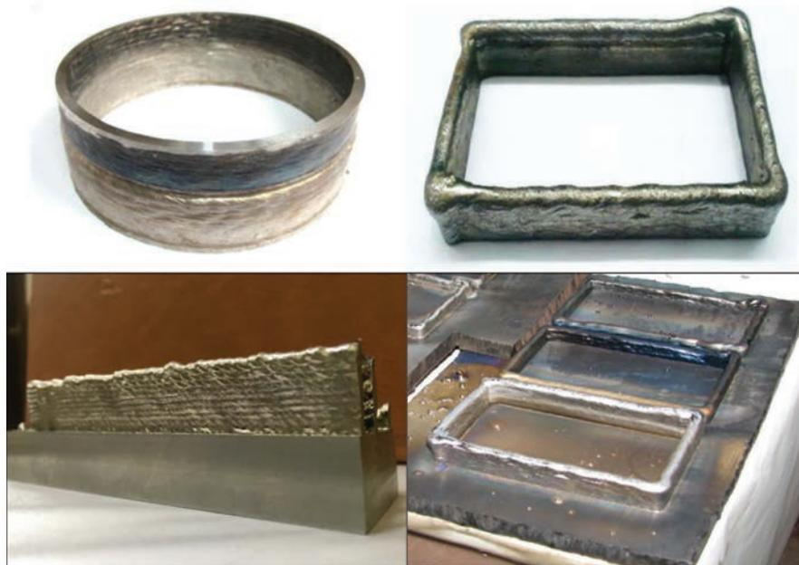
Рис. 7. Образцы, изготовленные по технологии DM
