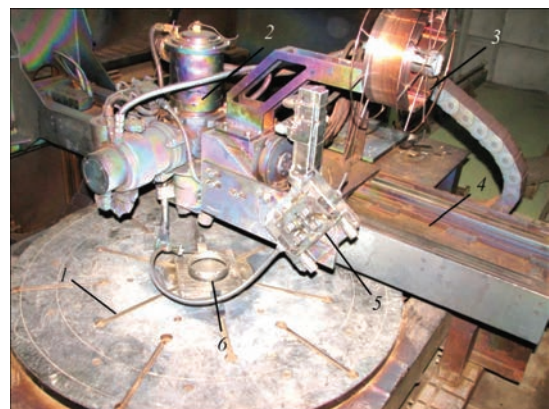
Рис. 6. Расположение оборудования для наплавки проволокой в вакуумной камере (описание 1–6 см. в тексте)
