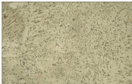
Рис. 5. Микроструктура ( \times 200 ) металла шва с повышенными механическими свойствами
