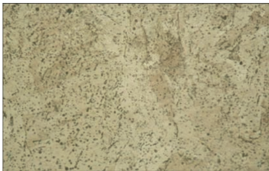
Рис. 3. Микроструктура ( \times 500 ) металла шва при легировании бором
