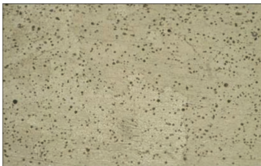
Рис. 2. Микроструктура ( \times 500 ) нелегированного металла
