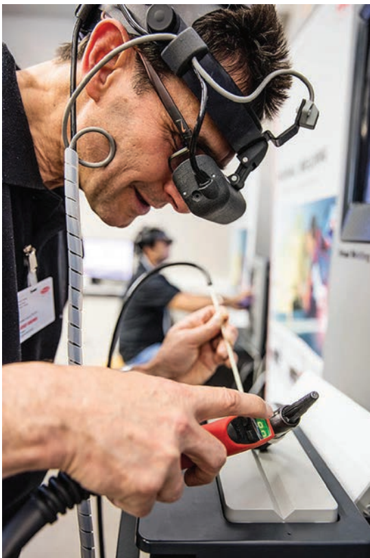
Рис. 2. Тренажер Virtual Welding позволяет ученикам отрабатывать навыки различных процессов сварки в виртуальных и при этом реалистичных условиях без риска получения травмы и расхода дорогостоящих материалов
