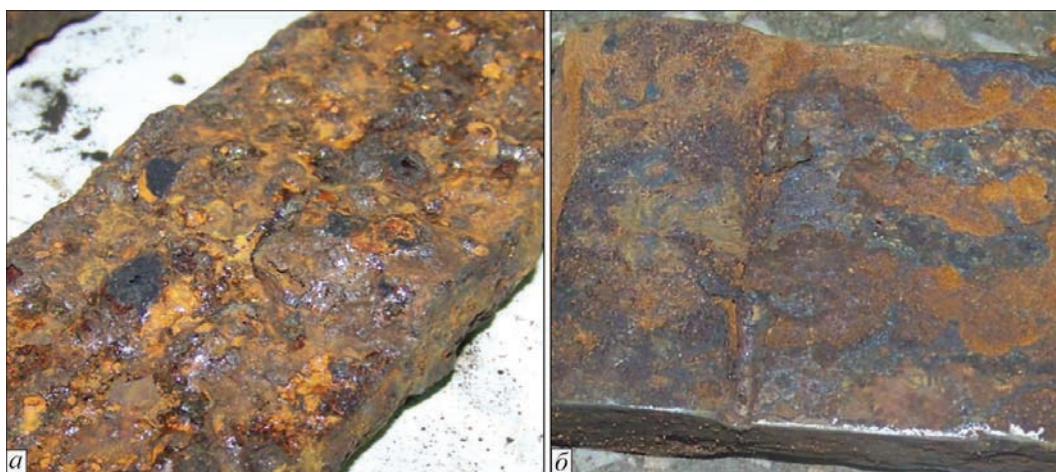
Рис. 2. Внешний вид зоны шва упрочненного технологией ВМП образца стыкового сварного соединения после выдержки в камере КСТ-1 на протяжении 1200 ч до (а) и после (б) частичного удаления продуктов коррозии
