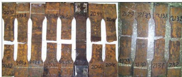
Рис. 5. Общий вид упрочненных технологией ВМП образцов стыкового сварного соединения после выдержки в камере КСТ-1 на протяжении 1200 ч и испытаний на усталость
