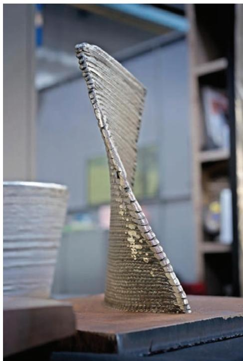
слоя наплавленно-го валика на предыдущий слой. Процесс WAAM может быть полностью автоматизирован от разработки идеи детали до ее изготовления в среде компьютерного проектирования, что сокращает время производства и объем человеческого вмешательства, необходимых для изготовления каждого нового продукта.
