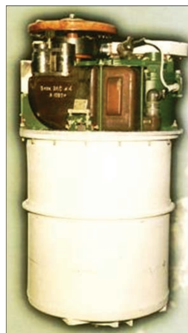
Автоматизированная сварочная установка «Вулкан»
