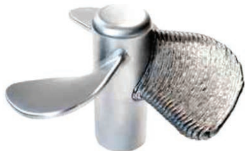
Рис. 2. Винт 200×240×240 мм (материал: 1.5125 G3Si1)
