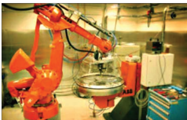
Рис. 6. Небольшая гибкая система. Интерфейс робот/корпус эффективно защищен от утечек, используя адаптируемое замыкание. Шкафы объемом до 27 м 3 были изготовлены для размещения больших систем
