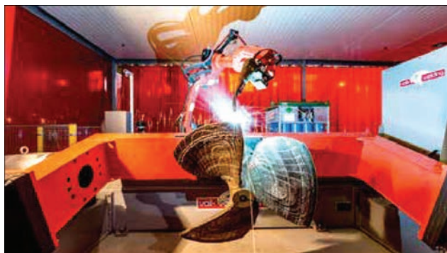
Рис. 5. Бронзовый винт 1300 мм, 180 кг
